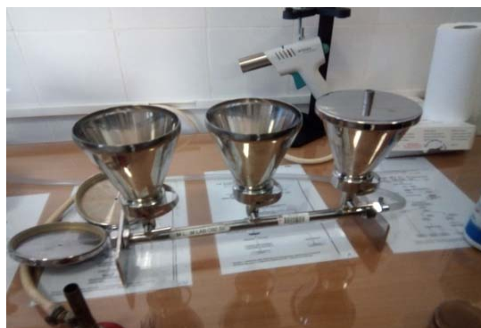
Figure IV.10 : Système de filtration sur membrane
