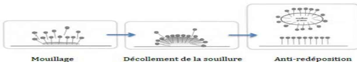
Figure II.4: Schématisation de l'action du détergent sur une souillure
