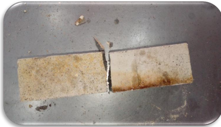
Figure IV.5 : Etat d'éprouvette après immersion de 28 jours dans 2% de \text{HCl}
