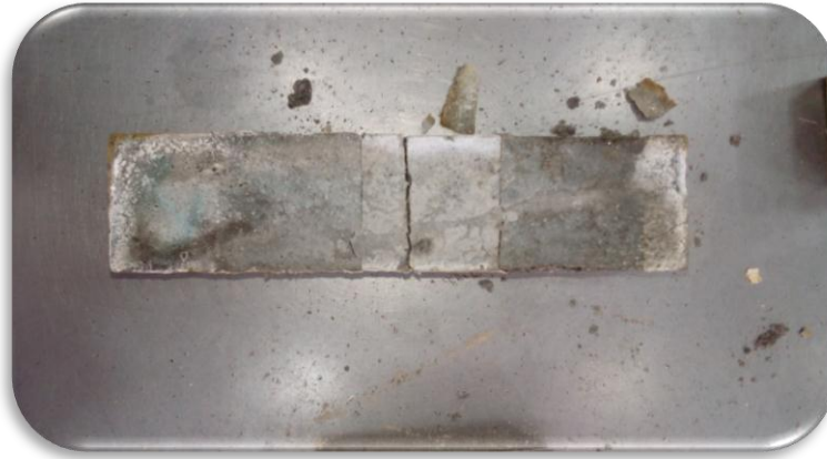
Figure IV.4 : Etat d'éprouvette après immersion de 28 jours dans 2% de \text{HClO}_4
