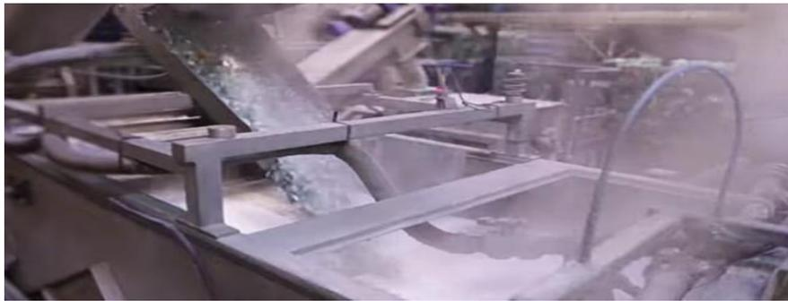
**Figure 28:** Machine de séparation des deux types de plastique.
