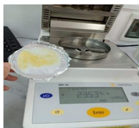
Figure 11 : Détermination de l'Extrait Sec Total par dessiccateur Infra-Rouge.
