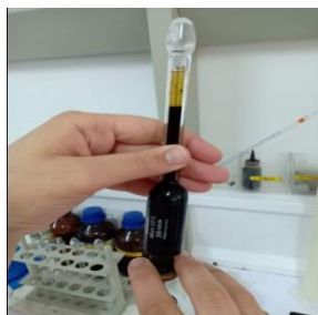
Figure 12 : Détermination de la teneur en matière grasse par le butyromètre de GERBER.
