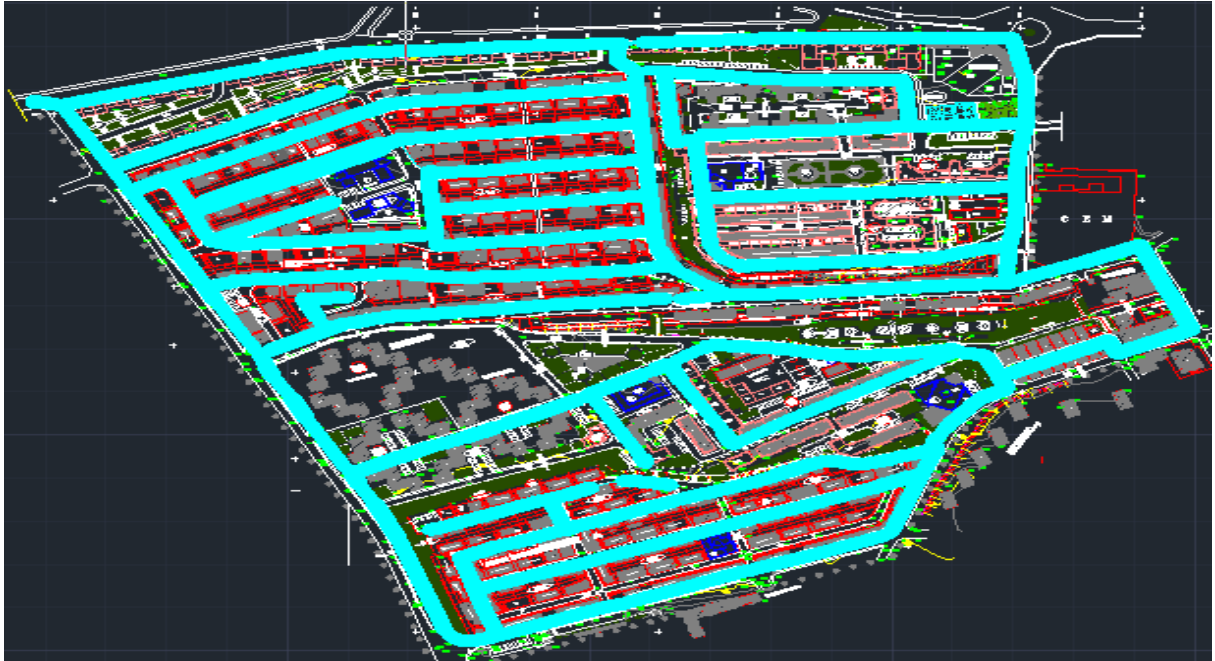
Figure IV-3 réseau de distribution sur autocad
