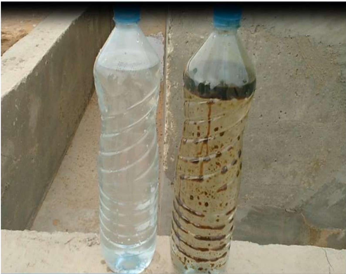
**Figure V.1:** échantillon entrée sortie du bassin de décantation CS2
