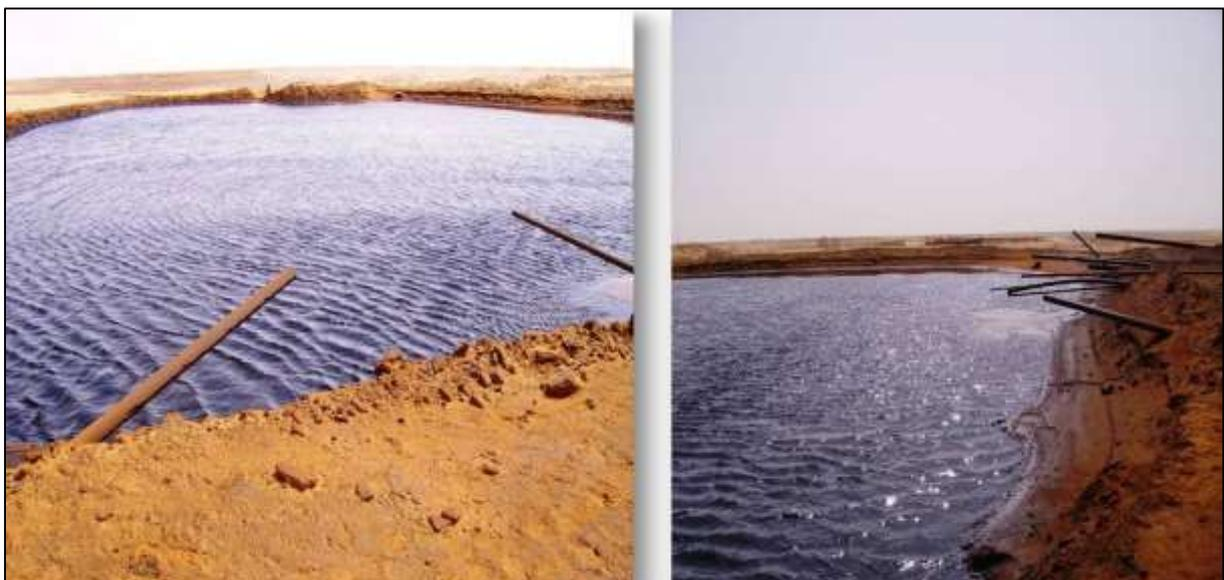
**Figure II.8:** Bourbier de décantation (décantation classique)
