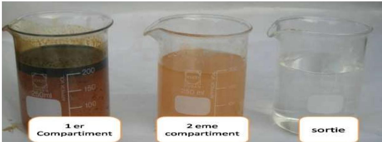
Figure V.2: Echantillon du premier, deuxième et sortie d'un bassin de décantation
