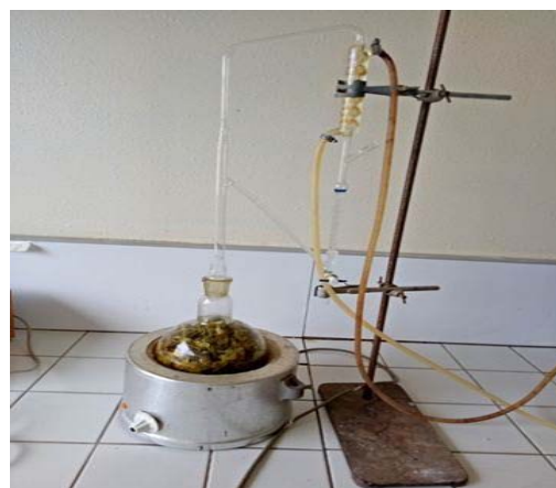
b. ballon contient 500ml \text{H}_2\text{O} distillée et 500g clou de girofle
