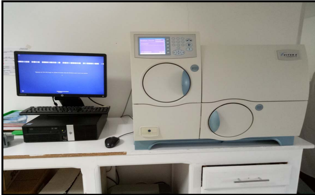
Figure 06 : L'appareille d'identification et antibiogramme des souches bactériennes (L'automate VITEK® 2) L'automate VITEK® 2)
