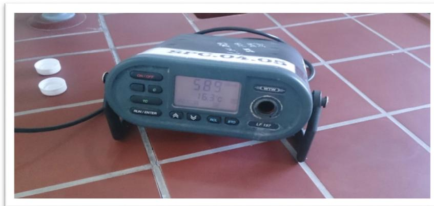
**Figure III.2 : Conductimètre.****III.5.3- Mesure de la turbidité :****a. Objet**
