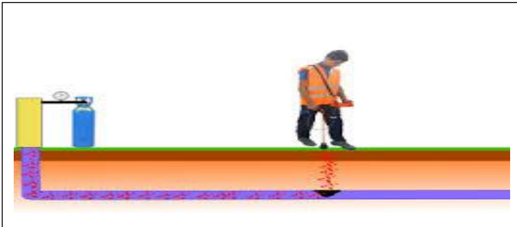
Figure 14: détection des fuites par Gaz traceur
