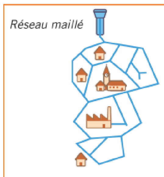
Figure 3:Schéma explicatif d'un réseau maillé
