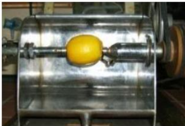
Figure 6: Dispositif de l'expression à froid (CHENNI, 2016).
