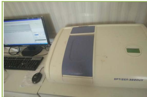
*Annexe II : Appareil spectrophotomètre.*
