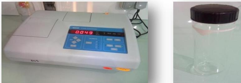
**Figure 30:** Turbidimètre et la Cuve.(Auteurs, 2019)
