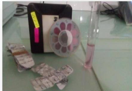
**Figure 29:** Appareil et matériel pour le test de Chlore.(Auteurs, 2019)
