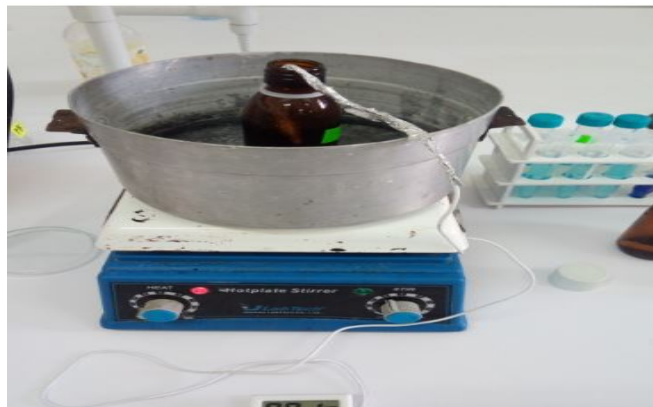
Figure 20 : Contrôle de la température de la solution à l'aide d'un bain marie et d'un thermomètre. (Alili et Larbi, 2019)
