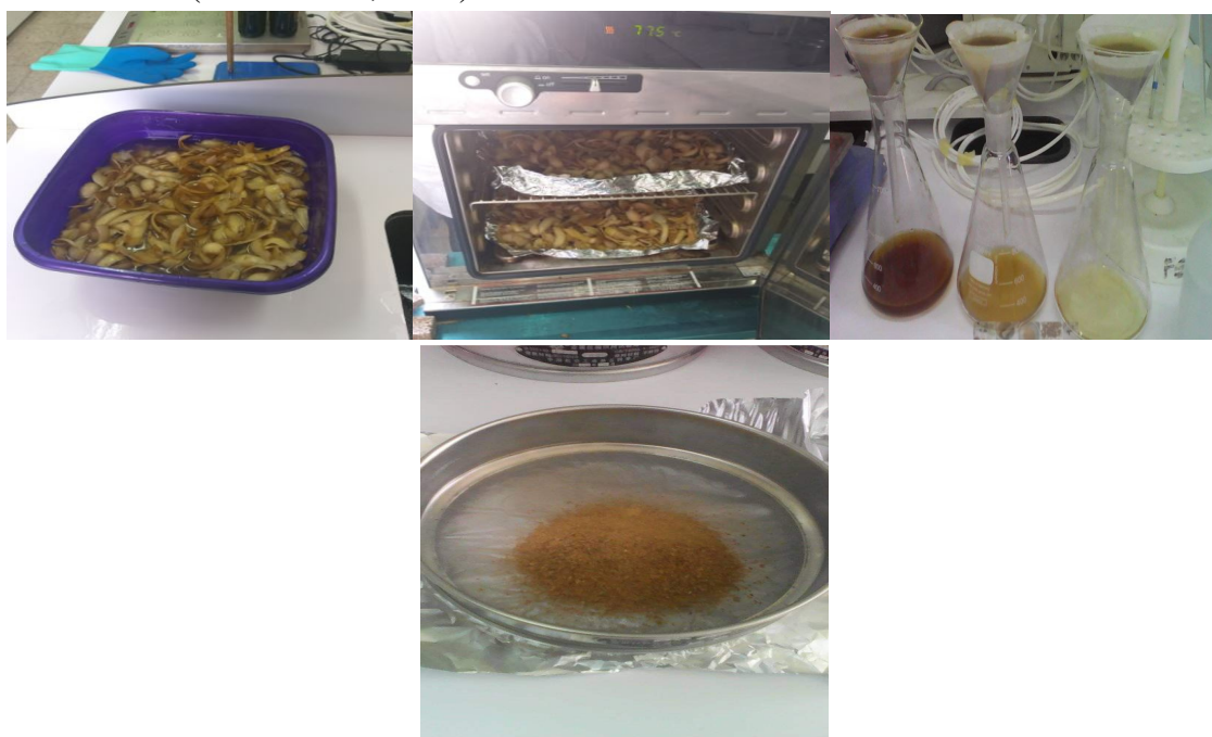
Figure 8 : Etapes de préparation du bioadsorbant (EPDT). (Alili et Larbi, 2019)
