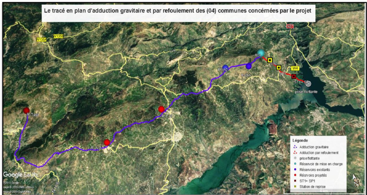
Figure IV.1: Le tracé en plan d'adduction gravitaire et par refoulement des (04) communes concernées par le projet
