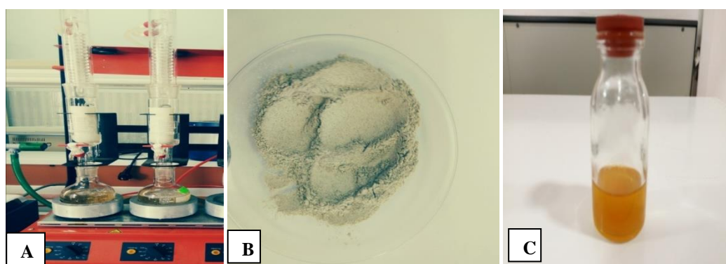
Figure05 : Photographie de la délipidation avec l'appareil Soxhlet : A-Montage de l'appareil soxlhet, B-Poudre obtenue après délipidation ; C : L'huile extraite.
