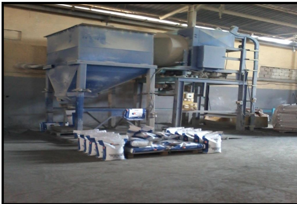
Figure I-5. Atelier des mortiers (malaxeur pour mélangé les matières premières).
