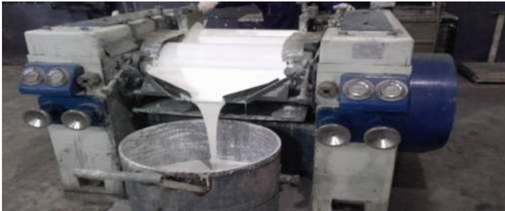
Figure IV- 2. Un broyeur afin d'obtenir la finesse désirée.
