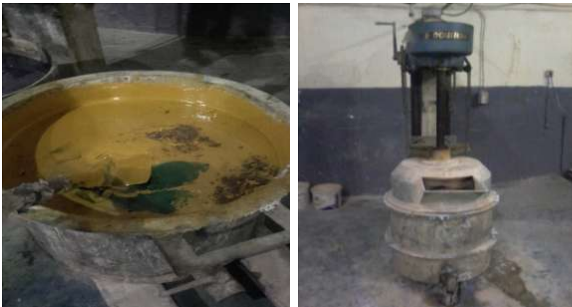
Figure IV-1. Un malaxeur pour homogénéiser les matières premières.
