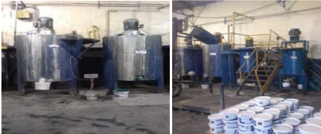
Figure IV-3. Un malaxeur pour avoir une couleur homogène.
