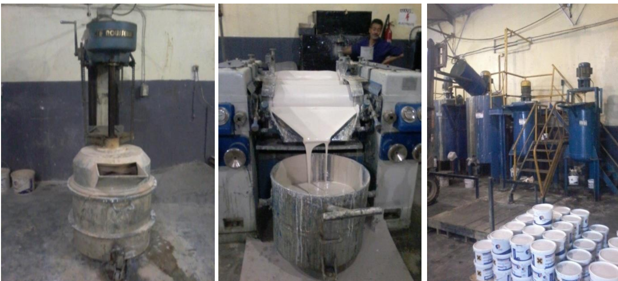
Figure I-7. Les différentes machines pour fabriquer les résines (malaxeur, un broyeur et un mélangeur).
