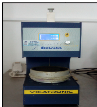
Figure II. 14: Appareil à VICAT automatique.
