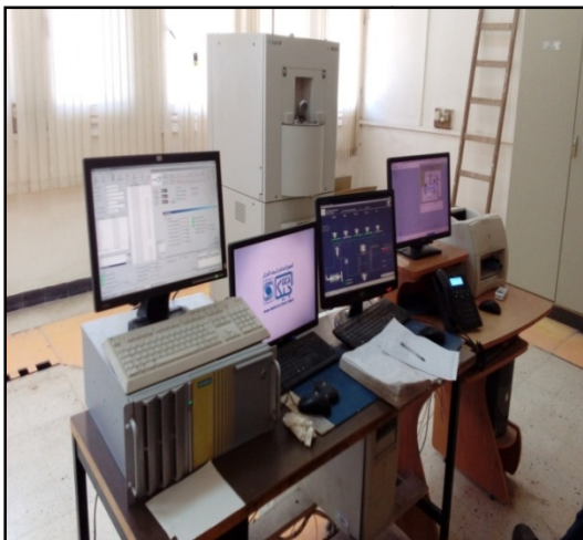
Figure II. 3: Spectromètre à rayons X.
