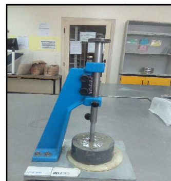
Figure II. 15: Appareil à VICAT.
