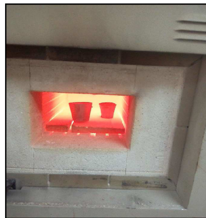
Figure II. 2: Les creusets dans le four à moufle.
