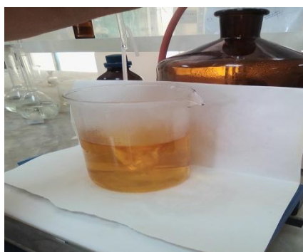
Figure II. 6: Titrage pour déterminer l'oxyde de fer.
