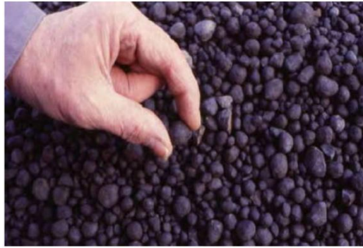
Figure I. 2: Clinker de Chlef de taille environ 5 mm.
