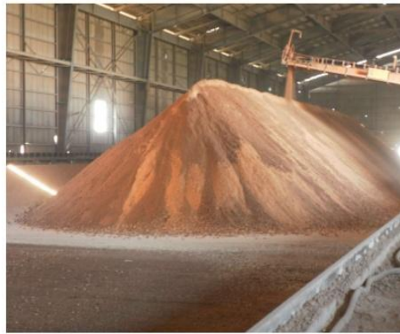
Figure I. 6: Hall de préhomogénéisation
