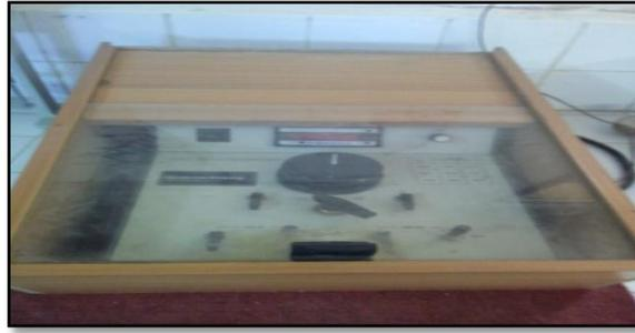
**Figure II.14:**Multi pycnomètre
