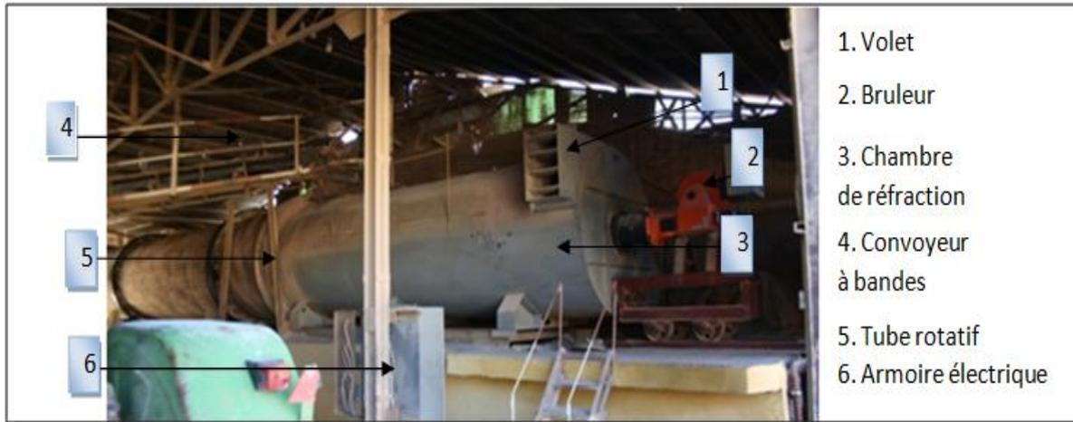
**Figure II.9:** Four du séchage
