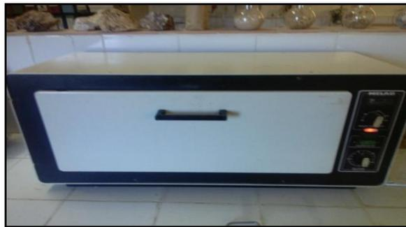
**Figure II.28:** l'Etuve (séchage à 100°C)
