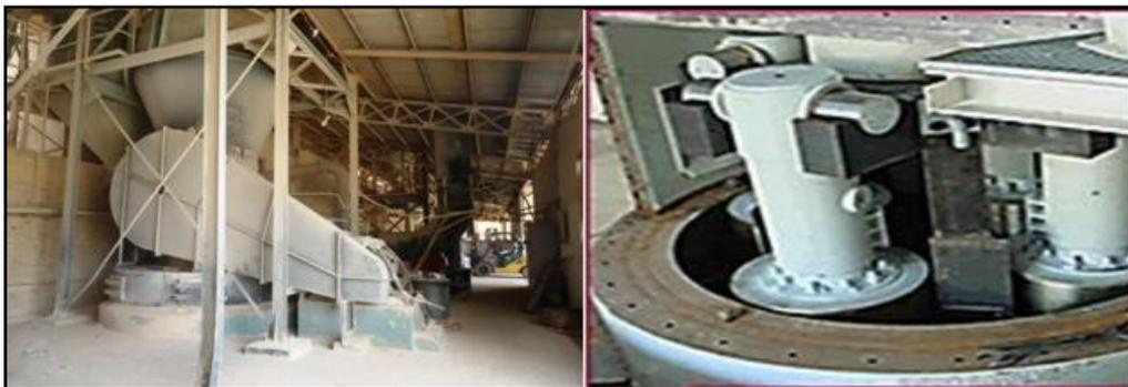
**Figure II.10:** Broyeur pendulaire BP16
