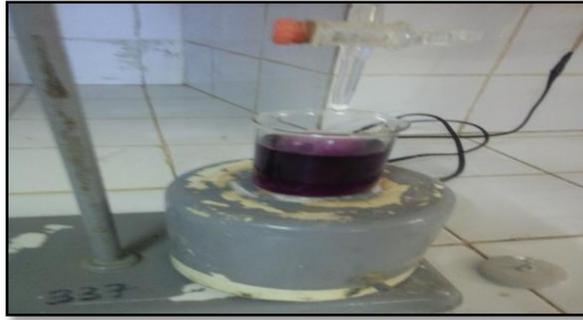
**Figure II.24:** Titrage du calcium par l'EDTA
