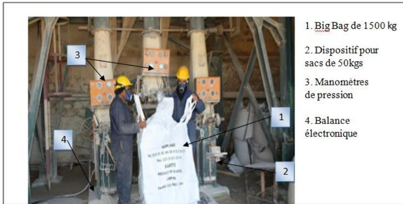
**Figure II.11:** Ensacheuse TESTUT
