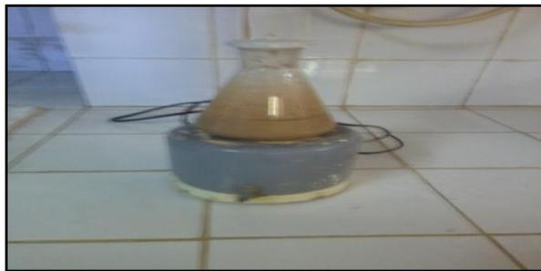
**Figure II.19:** Agitation de la baryte avec l'eau distillée
