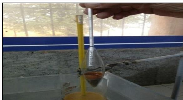
**Figure II. 34:** Hydromètre
