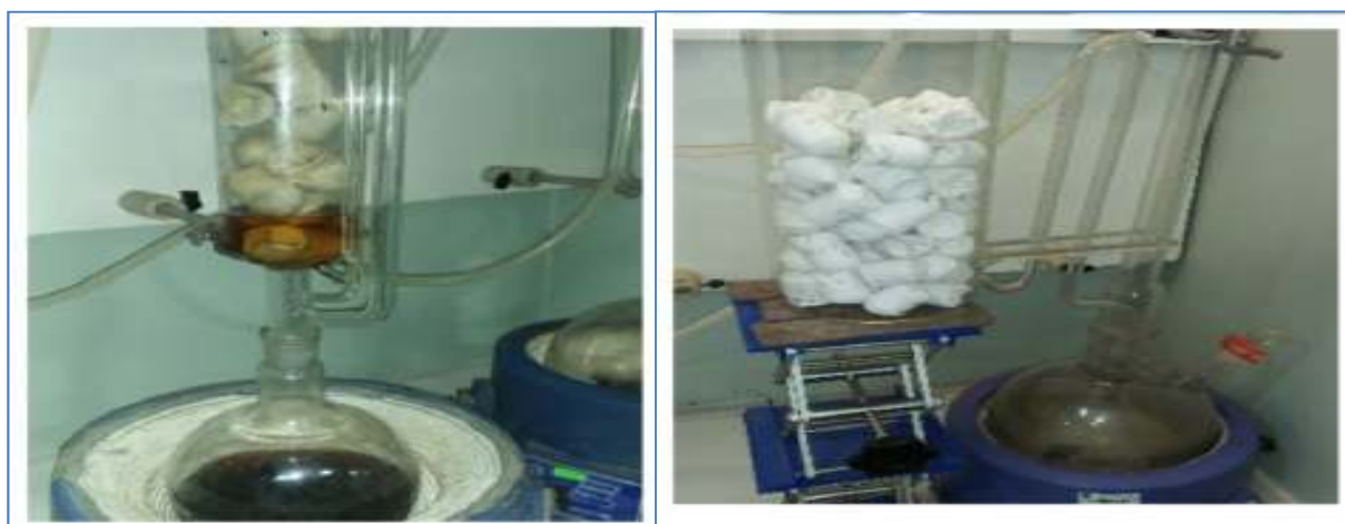
Figure III.1 : lavage à l'eau & DCM
