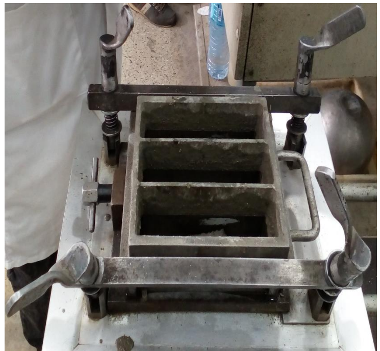
Figure 12 : un mortier contient 3 éprouvettes de Forme prismatiques 4×4×16 cm.
