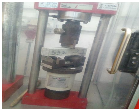
Figure 14 : Essai de la résistance par flexion.
