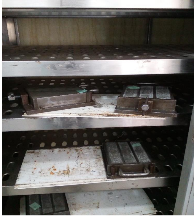
Figure 13 : Enceinte climatique pour la conservation des éprouvettes
