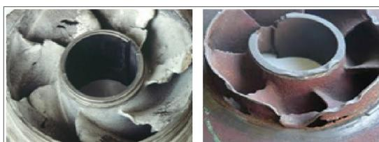
Figure 9: Effets de la cavitation sur les roues des pompes.
