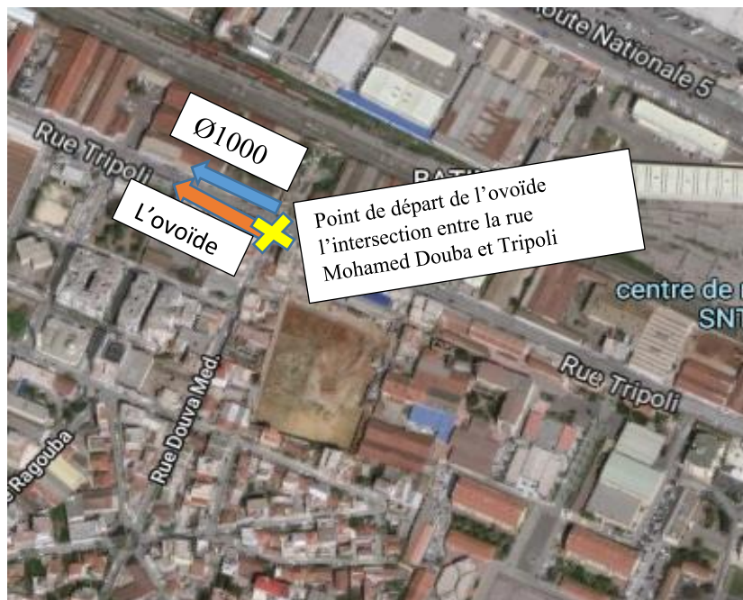
Figure N 0 10 : point de départ de l'ovoïde (0.7 x 1.0 m) et la DN1000
