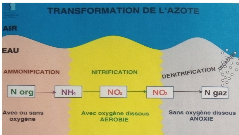
Figure. II.7-Schéma de procédé de transformation de l'azote.
