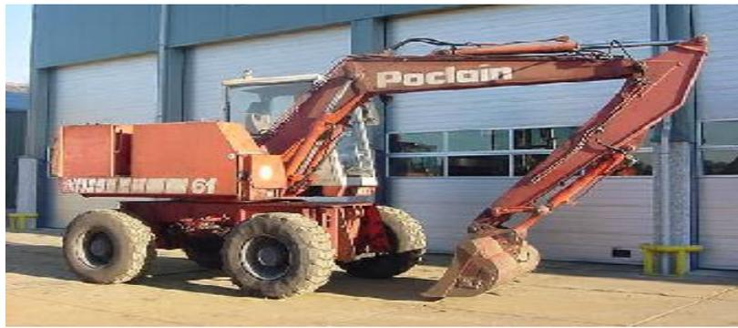
**Figure VI-5:** Pelle équipée en rétro
