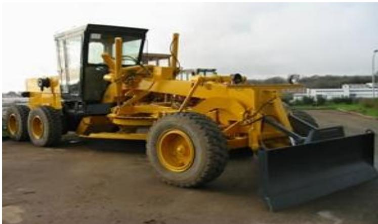
**Figure VI-4 :** *Niveleuse automotrice*
