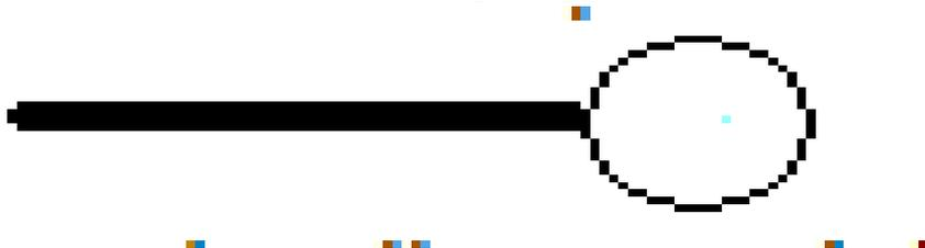
Figure 11 : Schéma d'une molécule tension actif non ionique
