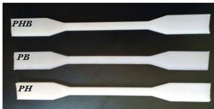
*Figure II. 11 : Echantillon sous forme d'haltère (Eprouvette)*
