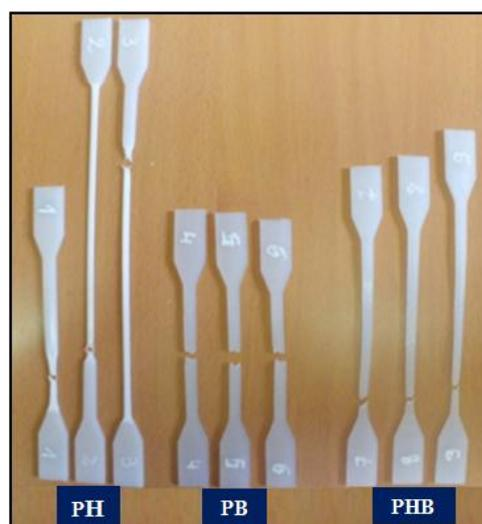
*Figure III. 4 : Echantillons après la traction*
