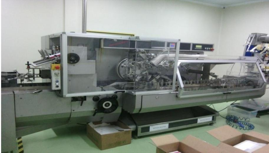
*Figure 12: Conditionnement secondaire (Encartonneuse)*
