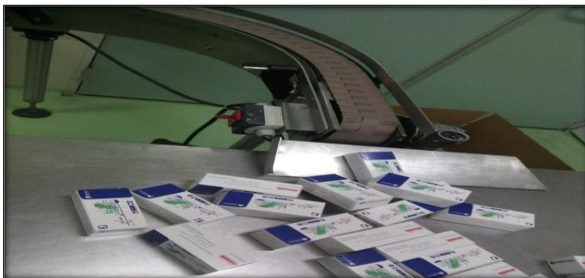
*Figure13:Tapie roulon de sortie les boites de RANITIDINE MABO*
