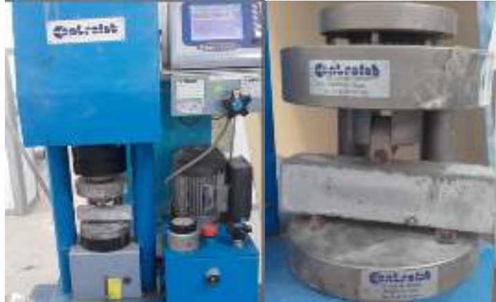
Figure III.4-L'essai de résistance à la flexion.
