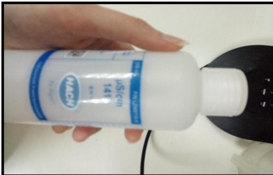
Figure III.16 : la solution des étalonnages.
