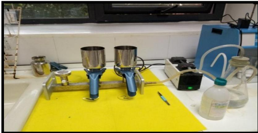
**Figure III.12** : Appareil de filtration.
