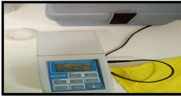
**Figure III.2** : l'appareille de mesure la turbidité.
