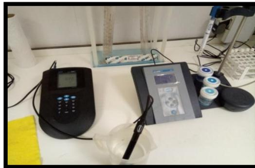
**Figure III.3** : Appareil de mesure de la conductivité.
