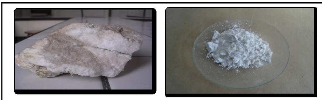
Fig. III.3. Le gypse avant et après le broyage.
