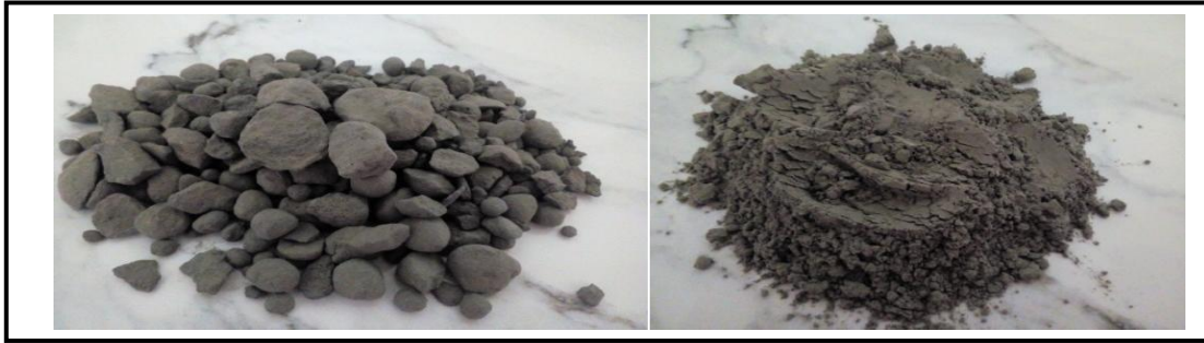
Fig. III.1. Le clinker avant et après broyage.
