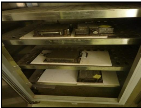
Fig. III.13. Chambre de conservation.
