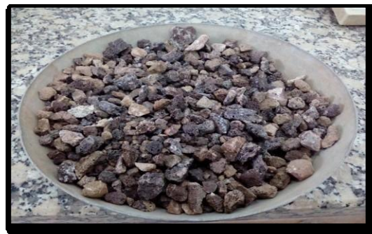
Fig. III.5. La pouzzolane naturelle de BENI-SAF avant broyage.
