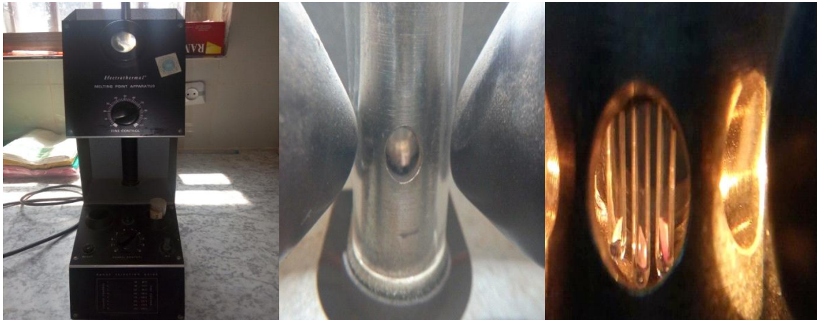
Figure 15 : appareillage et procédure de point de fusion
