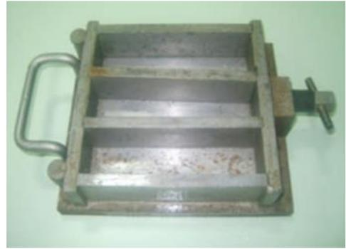
Figure 3.9: moule cubique et prismatique
