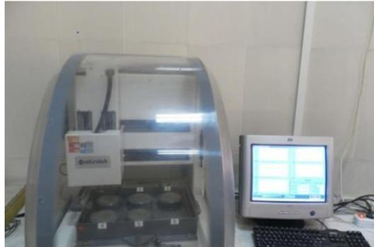
Figure 3.1: prisomètre automatique.
