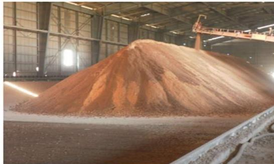
Figure 2.6: La préhomogénéisation roue pelles.
