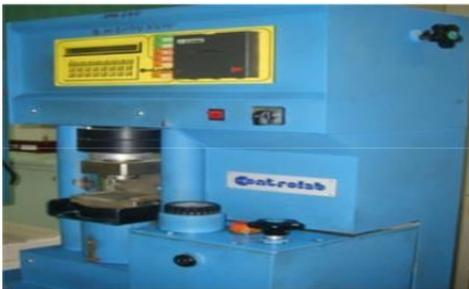
Figure 3.10: appareil de flexion
