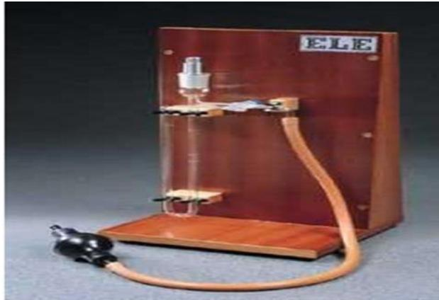
Figure 3.5: le perméabilimetre de Blaine.
