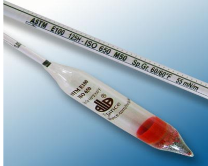
Figure III.6: Aréomètre normalisé selon la norme ISO 650
