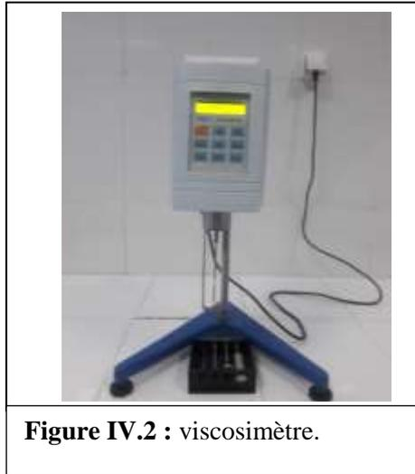
**Figure IV.2 :** viscosimètre.
