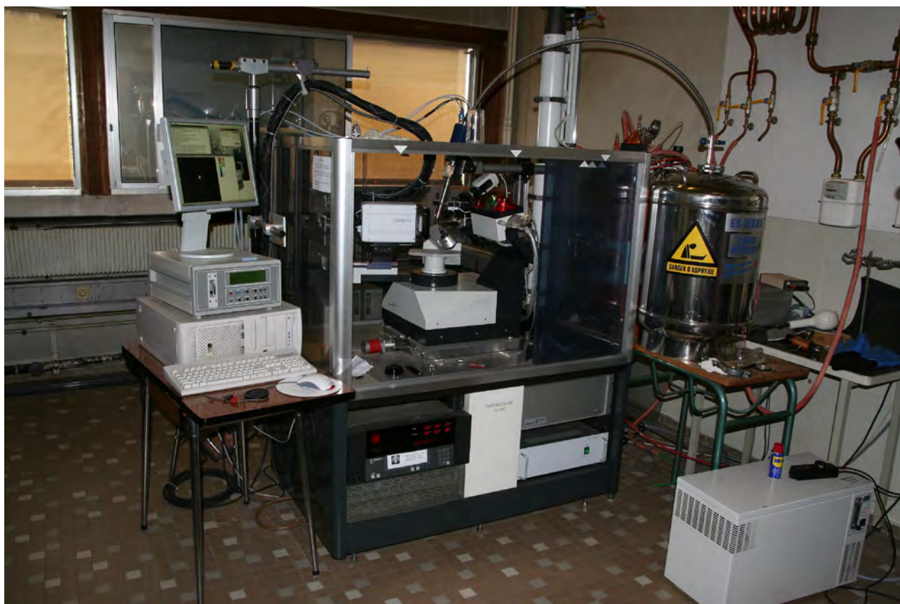
Figure III-3. Présentation du diffractomètre Kappa CCD APEX II du CRM 2 utilisé pour la collecte des données de diffraction du composé : 2-carboxyle-4-methylanilinium de chlorure monohydrate.
