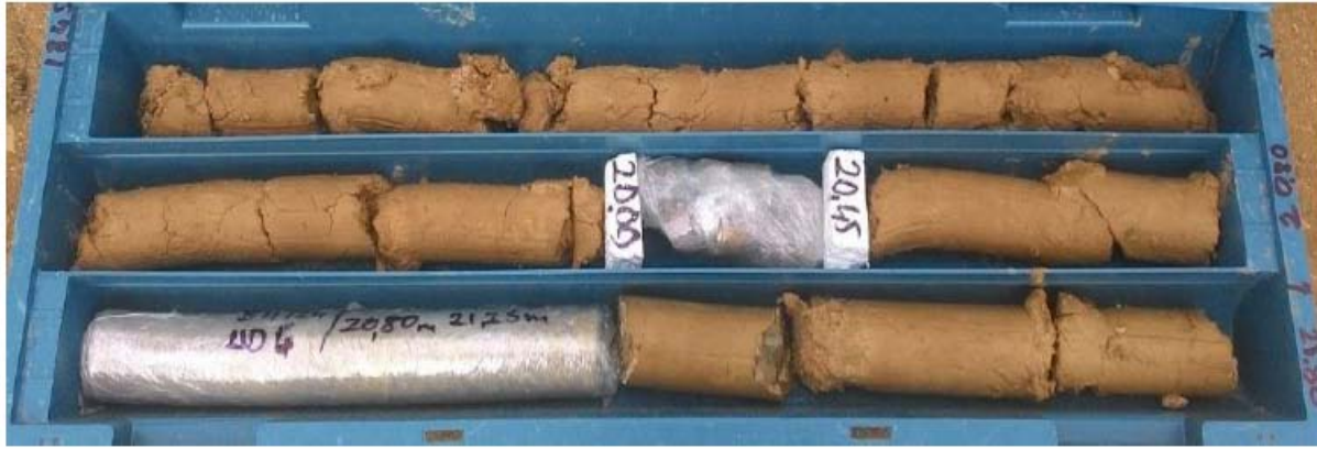
Figure 2-3-2 : Argile très solide/rigide observé dans le sondage BH-124 entre 6,00-35,20 m.
