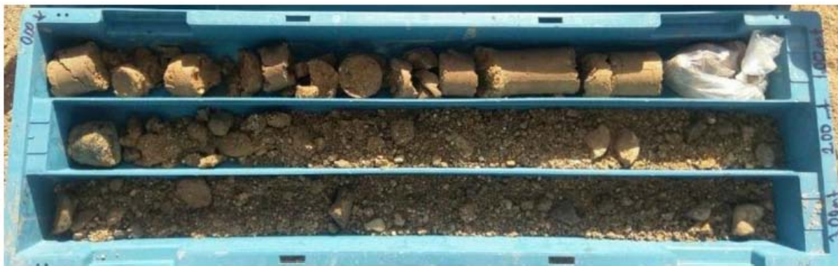
Figure 2-3-3 : Argile sablonneux/peu gravelé observé entre 0,00-1,00 m et argile sablonneux/gravelé observé entre 1,00-3,00 m dans le sondage BH-123
