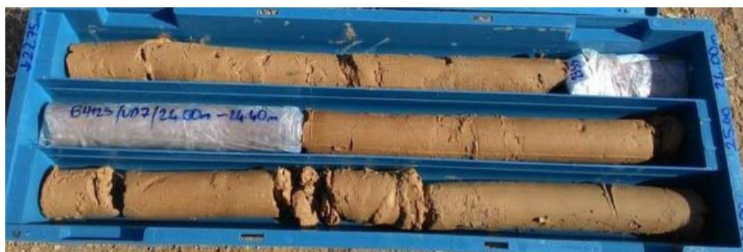
Figure 2-3-1: Argile très solide/rigide observé dans le sondage BH-125 entre 13,00-35,00 m.
