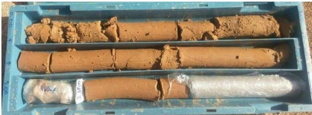
Figure2-3-4 :Argile très solide/rigide observé dans le sondage BH-122 entre 0,00-35,00 m.
