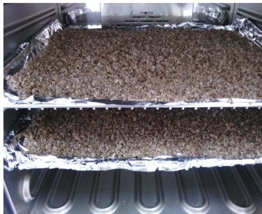
Figure III-4 : Séchage des épluchures de pomme de terre à 105 °C
