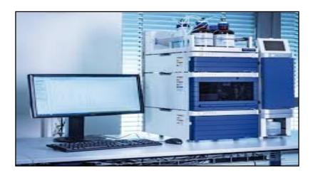
Figure 15: Chromatographie Liquide à Haute Performance. [62]
