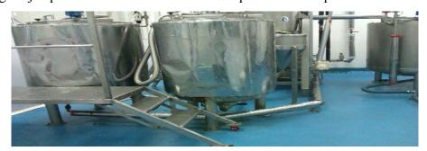
Figure 21 : Les cuves des phases (aqueuse (premix 113), et huileuse (premix 114)). [80] IV.3.Préparation de la crème :
