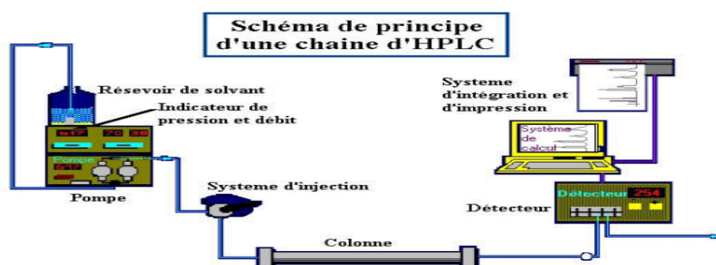
Figure IV.12 : Schéma de principe d'une chaîne d'HPLC [32].
