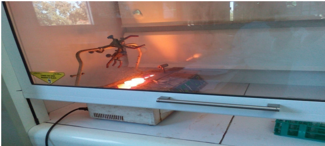
Figure IV.6 : Les creusets dans le minéralisateur.
