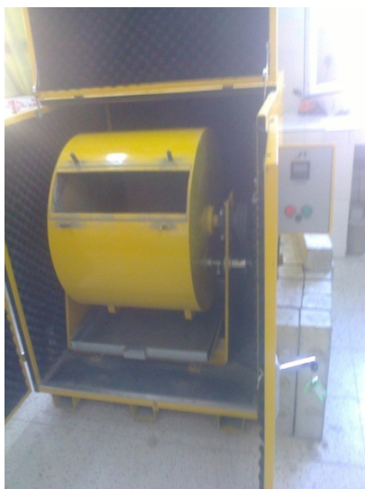
Figure II.3 :Broyeur « LOS ANGELES » et boules d’acier du broyeur
