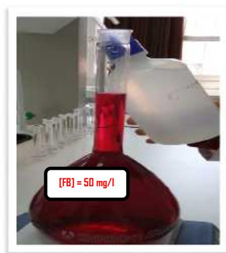
*Figure III -1 : Préparation de la solution de Fuchsine basique à 50 mg /l.*
