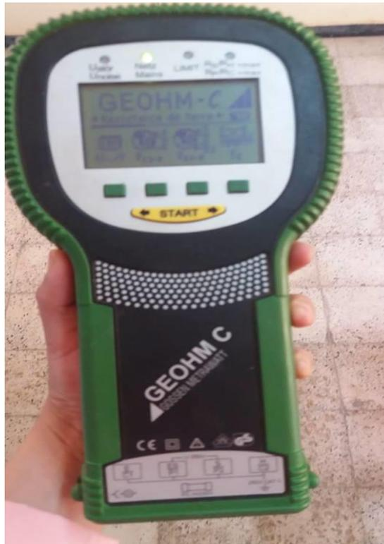
Figure IV.4 : L'appareil de mesure de la résistance et la résistivité du sol **GEOHM<sup>R</sup> C**.
