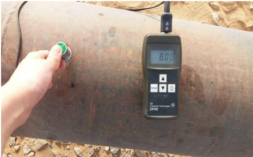
**Figure IV.8** : Prise d'épaisseur à CS1.
