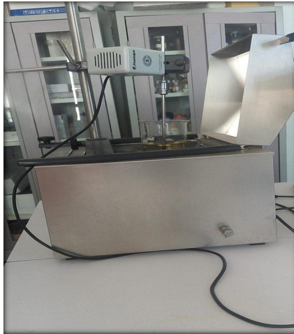
Figure III.4 : Installation de mise en œuvre du procédé d'adsorption
