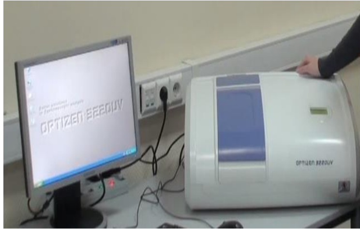
Figure II.3: spectrophotomètre Optizen 3220UV.
