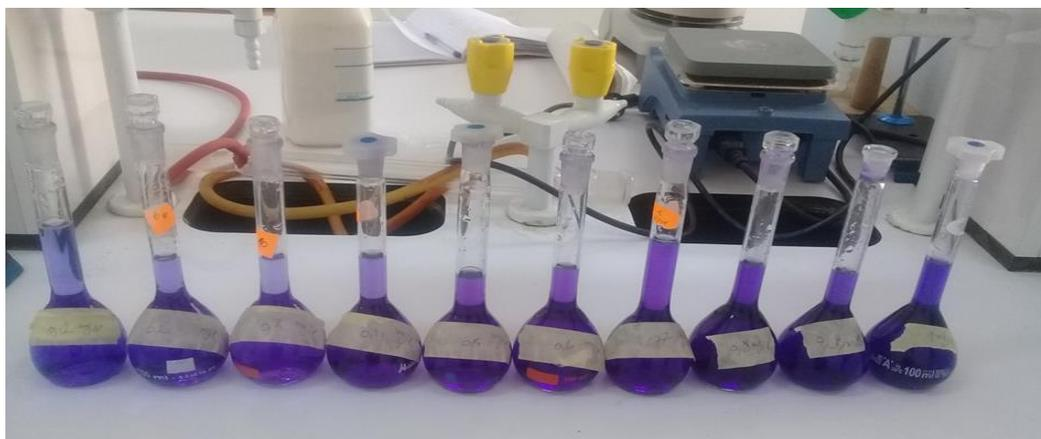
**Figure IV.2 :** Les solutions pour la courbe d'étalonnage.
