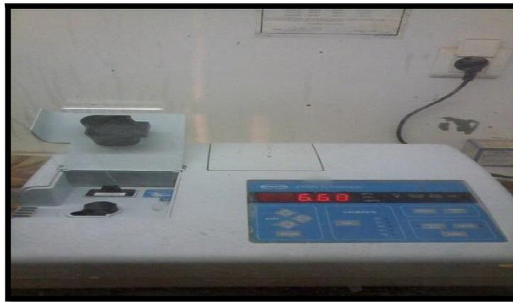
*Figure III.6 : Turbidimètre.*
