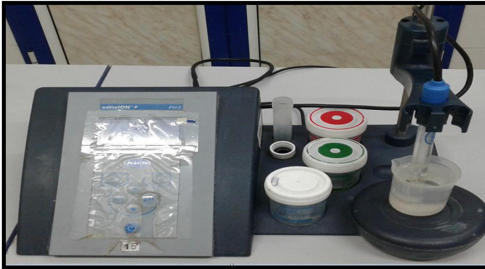
Figure IV.1 : pH mètre de paillasse HACH (sensION) de laboratoire de l'unité
