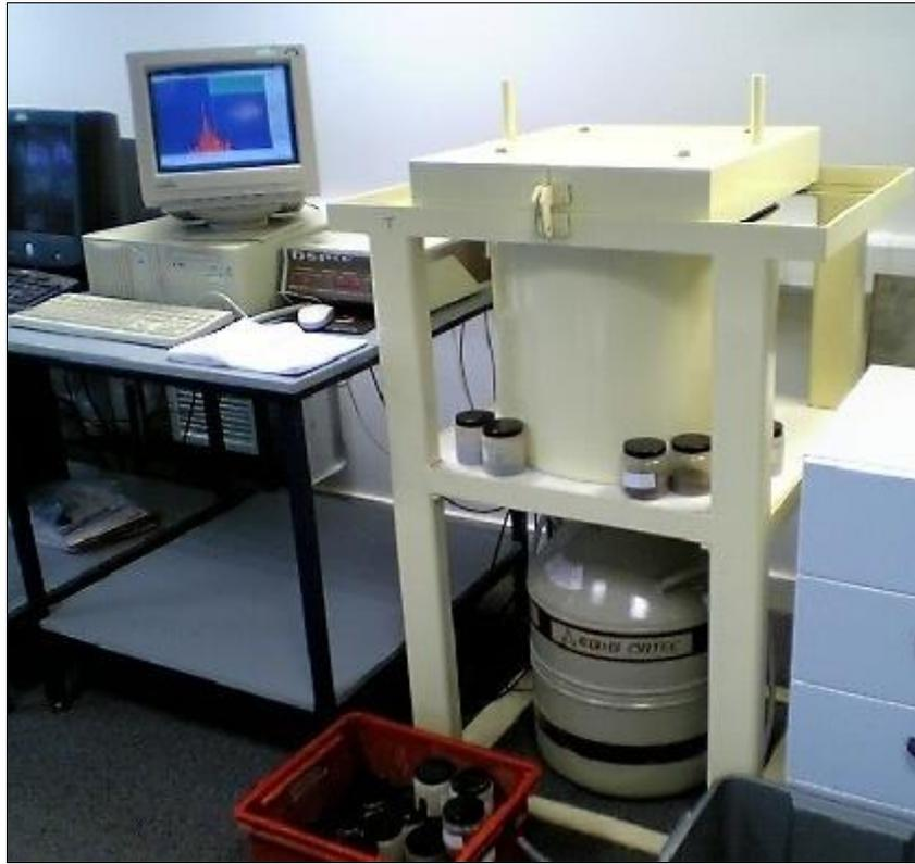
**Figure III.4:** Chaîne de spectrométrie gamma
